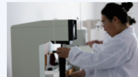
洛氏硬度试验 Rockwell hardness test
