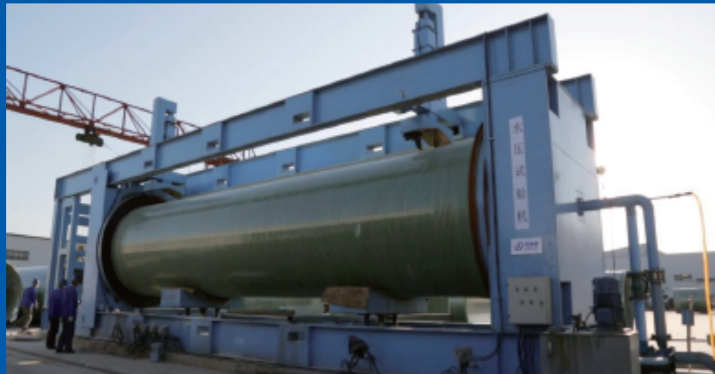
DN2400夹砂管水压试验 |
