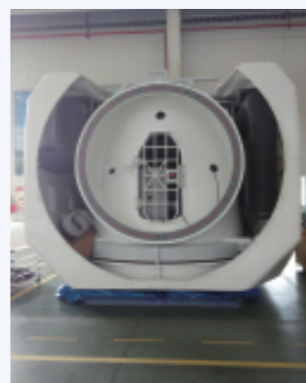
2.5MW机舱罩组装 |
