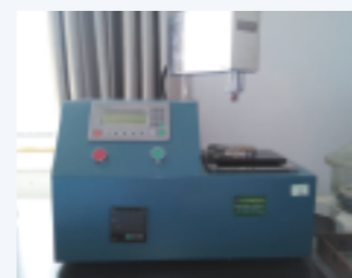
凝胶时间测定实验机
