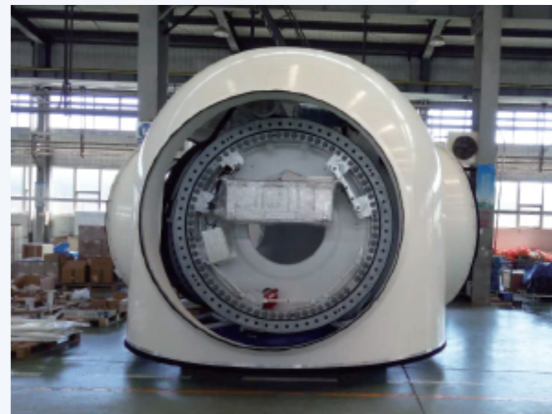
2.0MW导流罩组装 |
